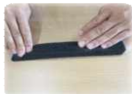
ラミネートの上部から5mm下に左右均等にスポンジをはりませす。
